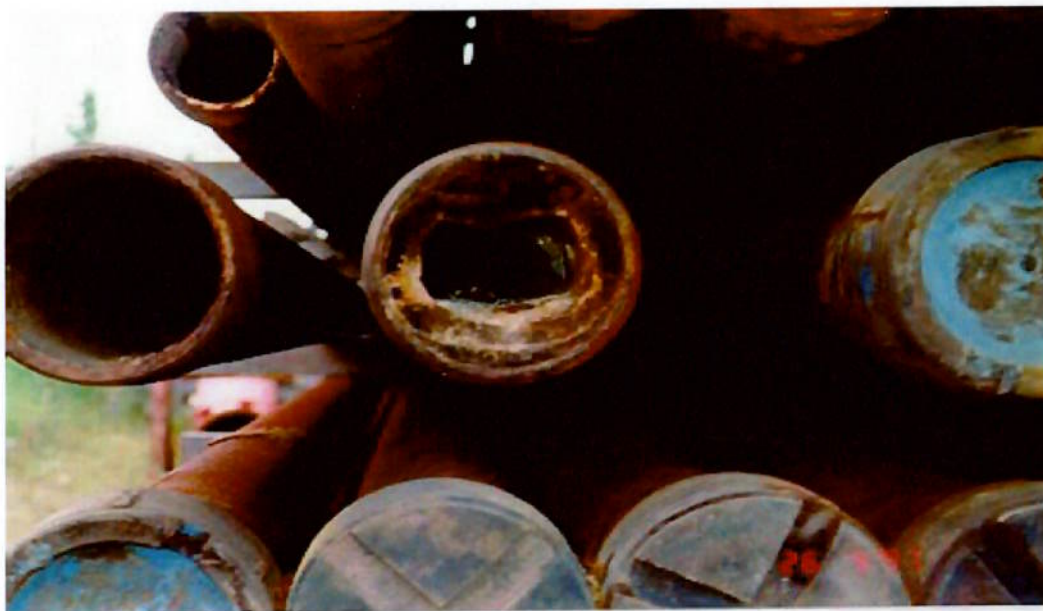
FIGURA 01 – tubos com incrustações de material radioativo de ocorrência natural.
