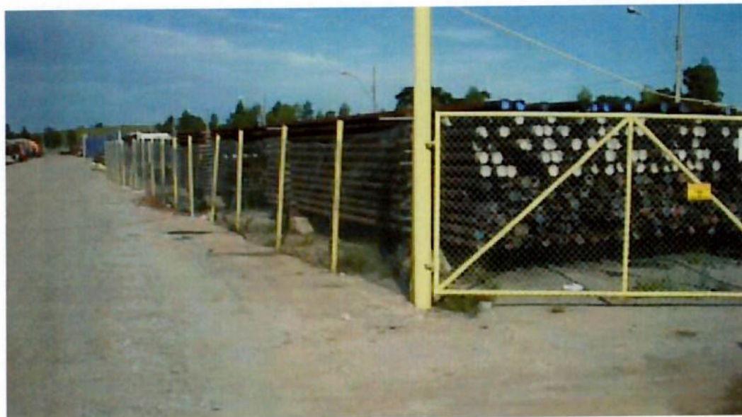
FIGURA 03 – Marimbondo, área destinada a armazenamento de tubos contendo incrustações com material radioativo de ocorrência natural (NORMS).
